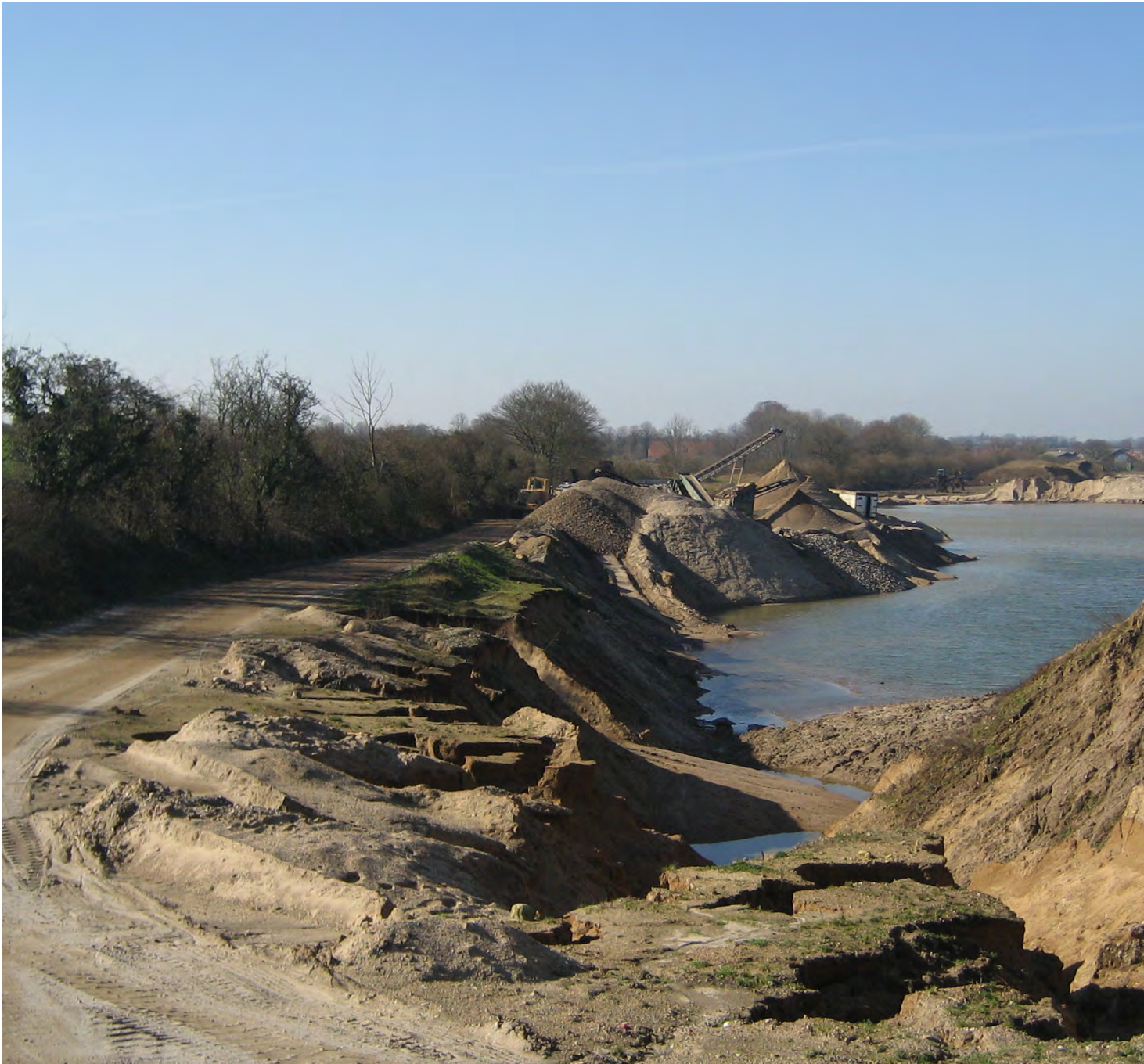
Gravning under grundvandsspejlet i råstofgrav ved Stepping. Foto: Kolding Kommune.
