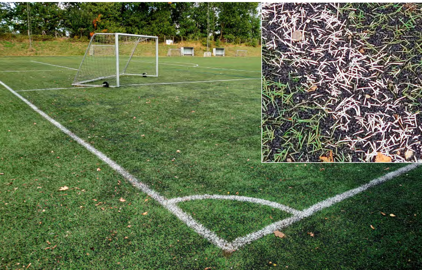
Kunstgræsbane med infill af gummigranulat. Foto: Kolding Kommune.
